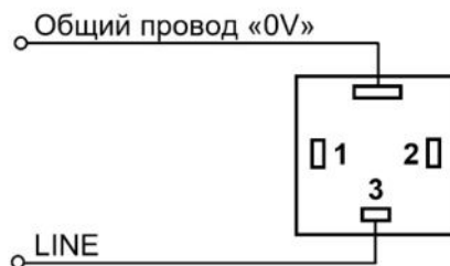
Рис.11. Схема «распайки» кабеля (вид со стороны «распайки» розетки) для подключения ДВ2ТСМ-1Т-1П-В.
